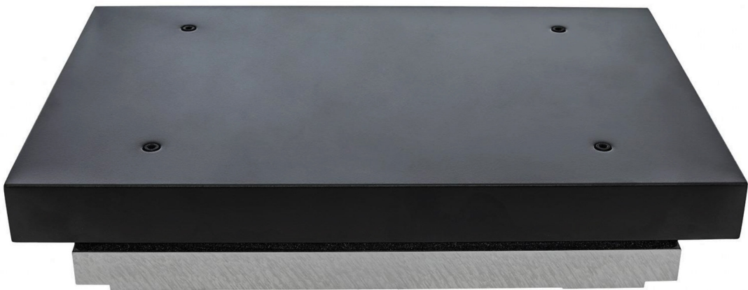
รูปที่ 5. แสดงอุปกรณ์แผ่นรองรับแรง (force plate) ที่ใช้ในการศึกษาคั้งนี้
