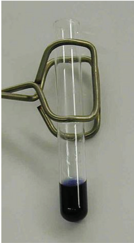
รูปที่ 16. รูปถ่าย ปฏิกริยาตัวอย่างที่มี THC ภายหลังจากเติมน้ำยา Duquenois-Levine และปรับ pH เป็นกรดภาพขาวเป็นปฏิกริยาภายหลังจากการเติม chloroform
